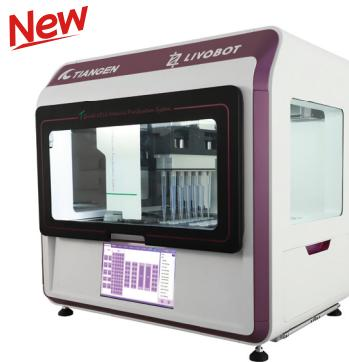
TGuide LP12基于磁珠法纯化核酸原理，配置单通道移液枪和12通道移液枪全自动完成从菌体沉淀上机后的质粒提取流程，一体机运行中途无需人工介入，提取产物自动存储于1.5/2.0 ml收集管中。
